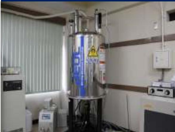
溶液・固体サンプルのスペクトル測定によりCHN等の原子の配列や数また隣接あるいは遠隔の原子間の相互作用についての知見が得られる分子構造解析に必須装置です。
