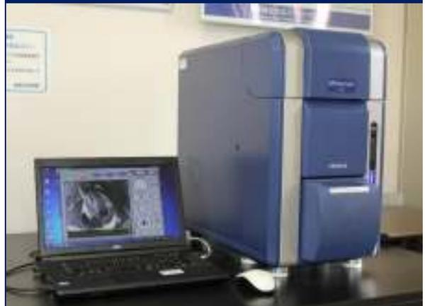
低真空な環境で比較的簡素な操作により観察が可能な、走査型電子顕微鏡です。生物試料や多少水分を含んだ材料などを、前処理不要で より自然に近い状態で観察できます。
