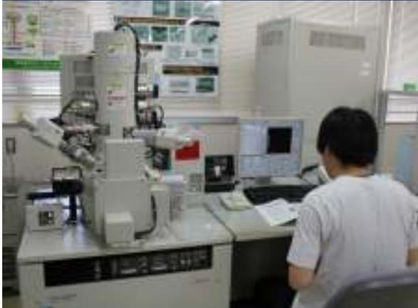
イオンのビームを使用して、微小領域における材料の切断や掘削加工を行うことができます。電顕観察用の試料作製や超微細加工が可能で nm単位での解析などへの応用にも便利です。
